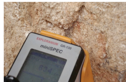
Conteo radiométrico en cuarzomonzonita meteorizada, con ortoclasa y plagioclasa.
