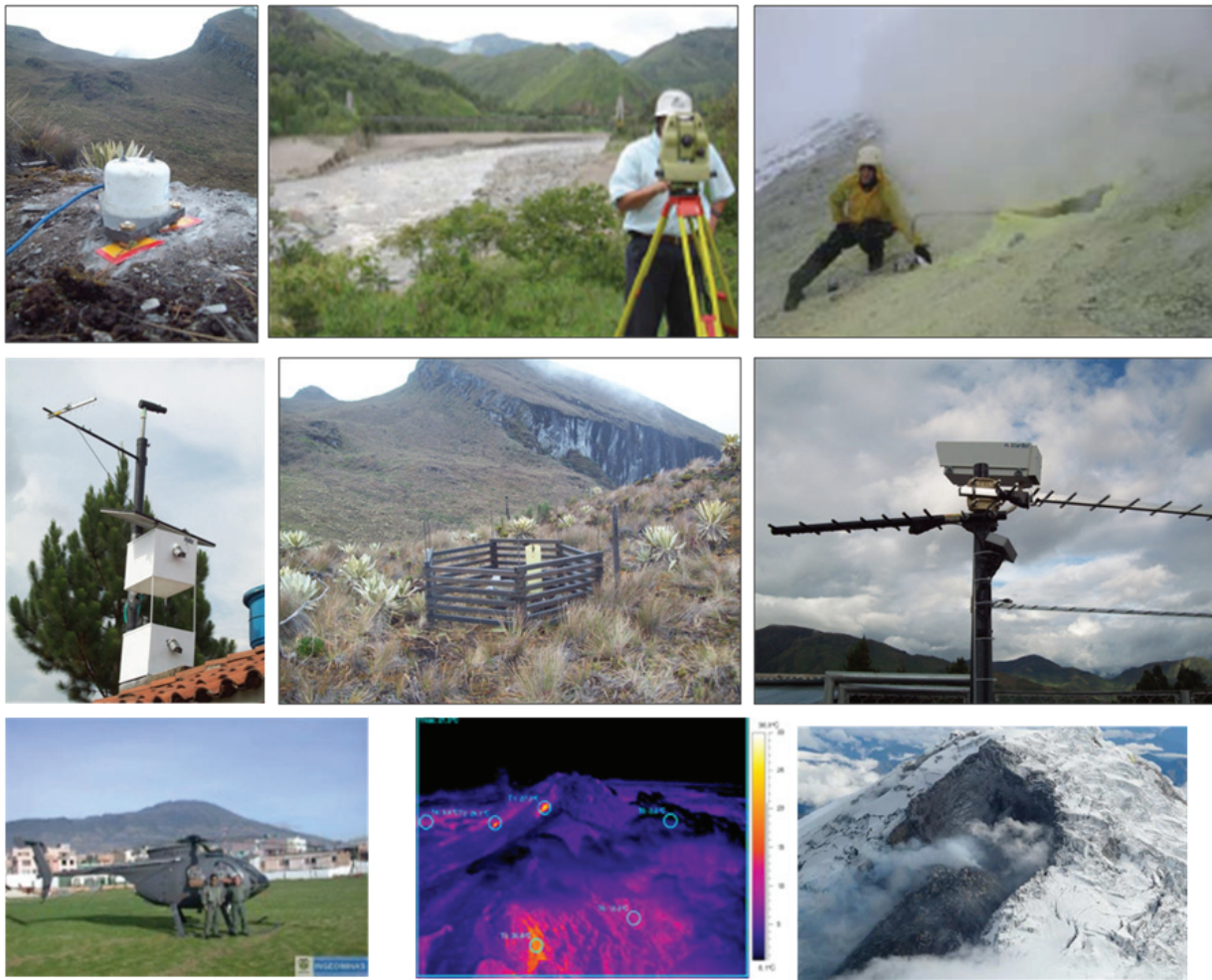
Imágenes de equipos y metodologías térmicas empleados en el monitoreo de volcanes activos: inclinómetros electrónicos, distanciómetro, Scandoas, sensores acústicos, helicóptero, cámaras Web y cámaras térmicas.
